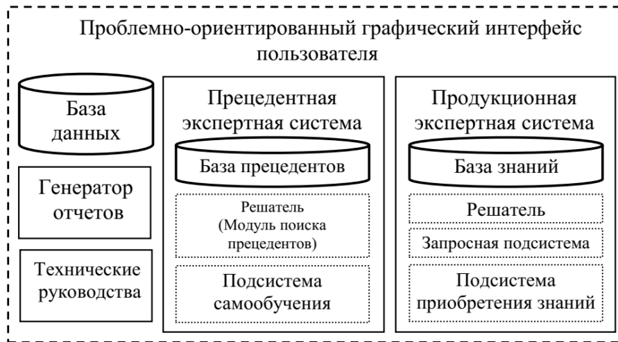
Рисунок 1 – Принципиальная архитектура АвиаТехПом
