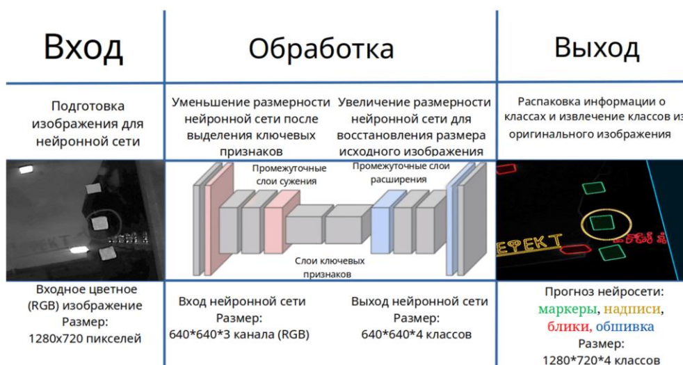
Рисунок 6 – Принцип обработки изображений контрольных маркеров на поверхности остекления нейросетью
