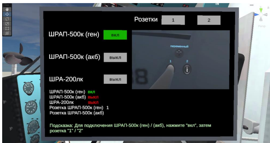
Рисунок 14 – Подключение ШРАП-500к (ген)
