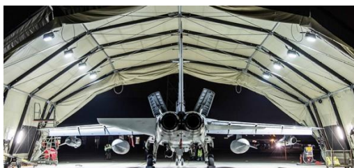
Рисунок 4 – Быстровозводимое укрытие EFASS, под которым стоит самолет.
