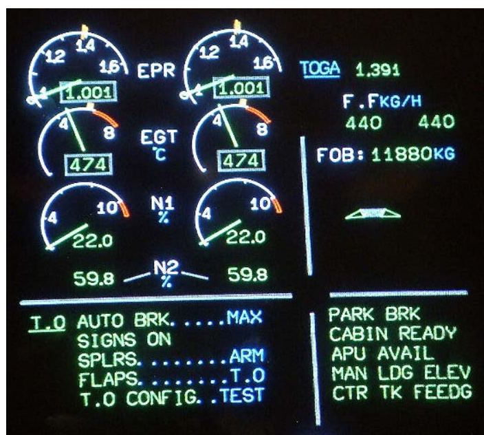
Рисунок 2 – Вид EWD самолёта Airbus A320 [Airbus A320 ECAM displays]
